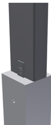
Afbeelding 1 Detail binnenkolom met strip
