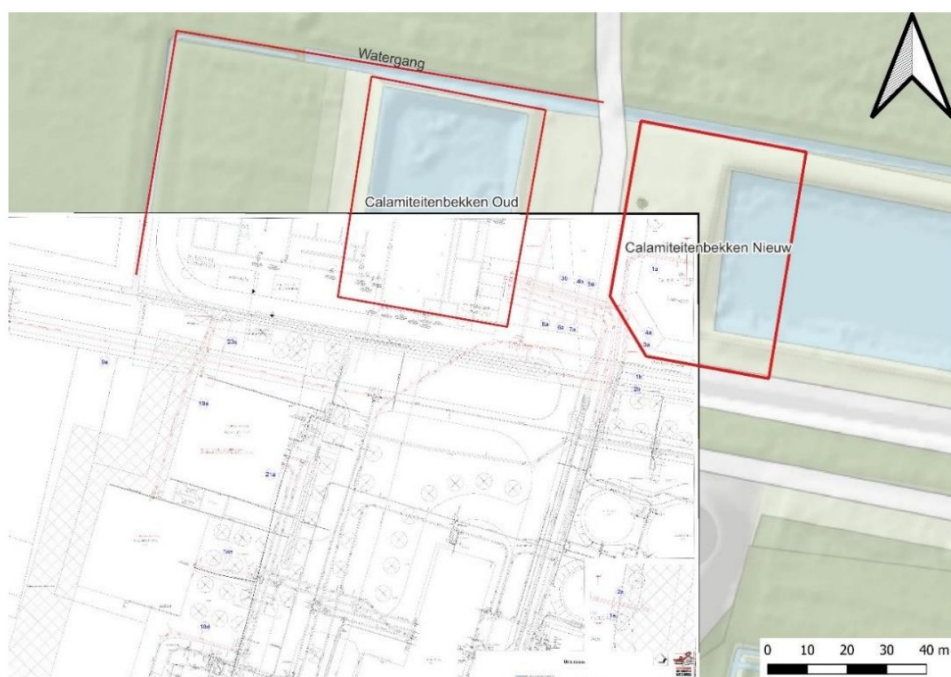
Figuur 1.1: Locatie constructies en te verwijderen leidingen
