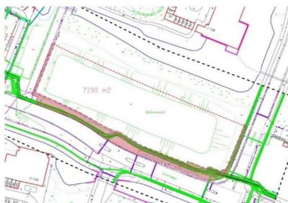
Afbeelding 14: roze zone met kabels en leidingen
