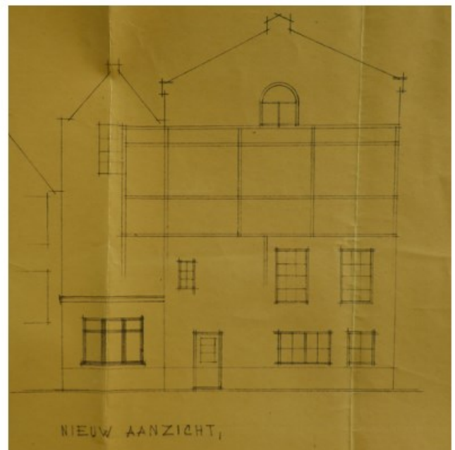
Afb. 3.21 Een viertal foto's van de bouwtekening die bij het dossier uit 1944 is gevoegd. Het betreft de verbouwing van een keuken op kelderniveau. De tekening toont diverse aanzichten (bestaand en nieuw); de overige tekening zijn steeds van de nieuwe situatie. SAMH 1358.877
