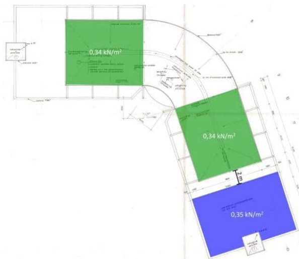
Dak capaciteit na verwijdering van ongeschikte zones.
