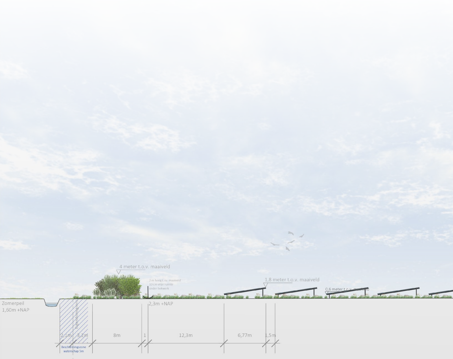
Afbeelding 8. Doorsnede A van zonneveld Kanaaldijk-Zuid met links de nieuwe landschappelijke haag en rechts het bestaande struweel met bomenrij.
