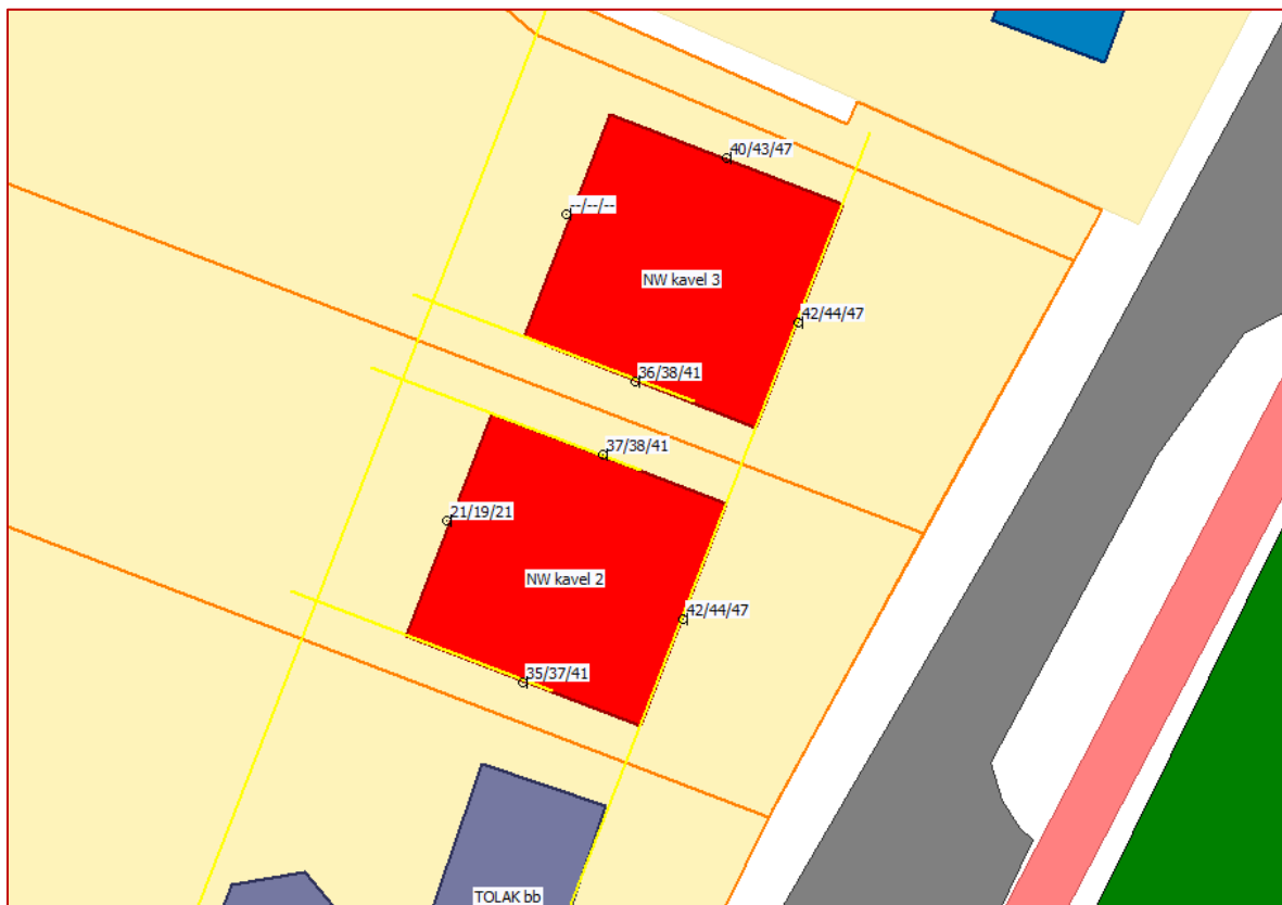
Figuur 4.4: Rekenresultaten geluidbelasting vanwege railverkeerslawaai
