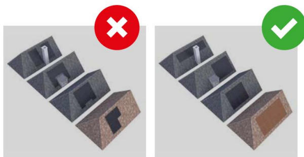
Onjuiste plaatsing van zonnepanelen
