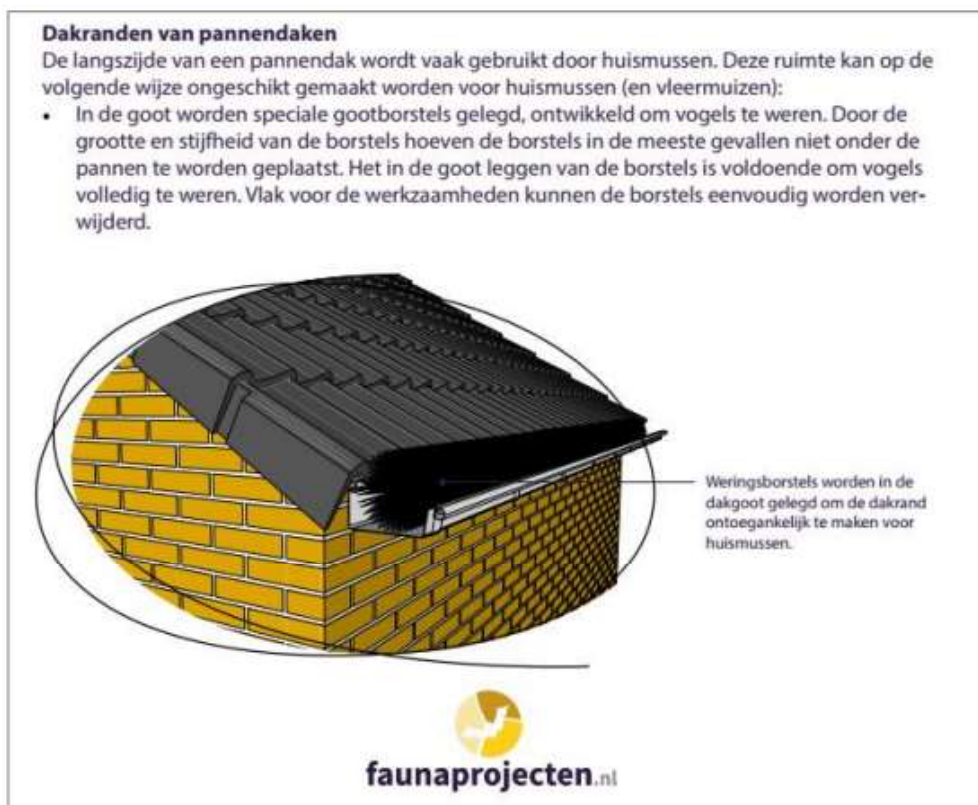
Figuur 3 Plaatsing weringsborstels
