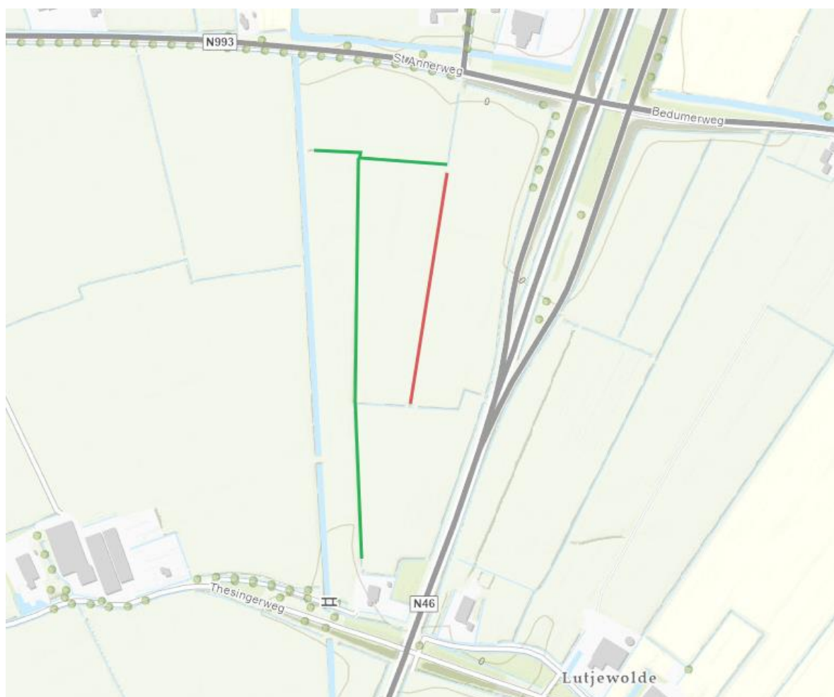
Figuur 1: Locatie van werkzaamheden. De rode lijn geeft te dempen watergang weer. De groene lijnen geven te verbreden watergangen weer.
