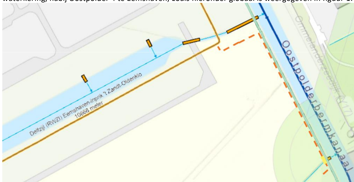
Figuur 1: Kabeltracé weergegeven met oranje stippellijn, boogzinker/mantelbuis weergegeven met gele lijn, beschermingszone primaire waterkering weergegeven met lichtgroene vlak. Ter informatie is de aanwezige persleiding van het waterschap weergegeven met een bruine lijn.
