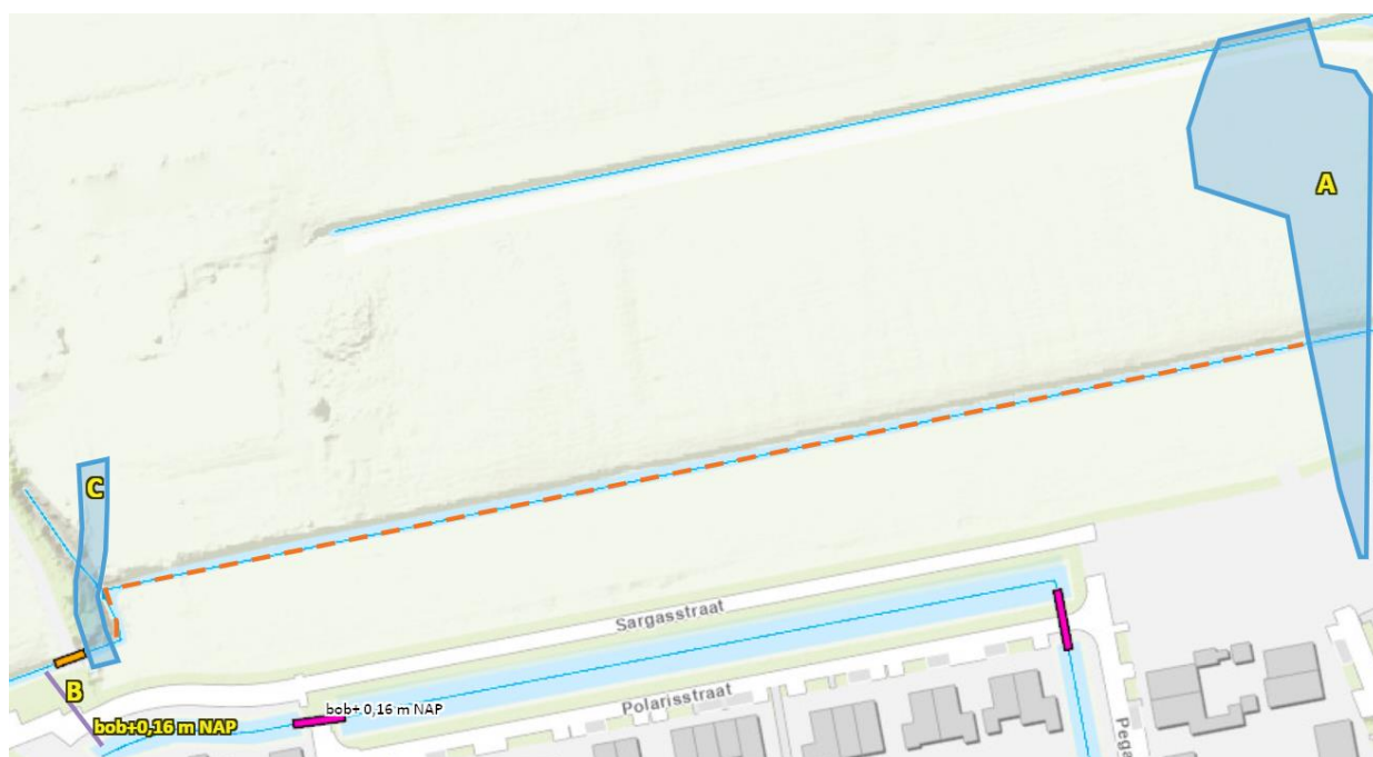
Figuur 1: Te dempen watergang weergegeven met oranje stippellijn, te graven nieuwe wateren weergegeven met A en C, benodigde nieuwe duiker weergegeven met B.
