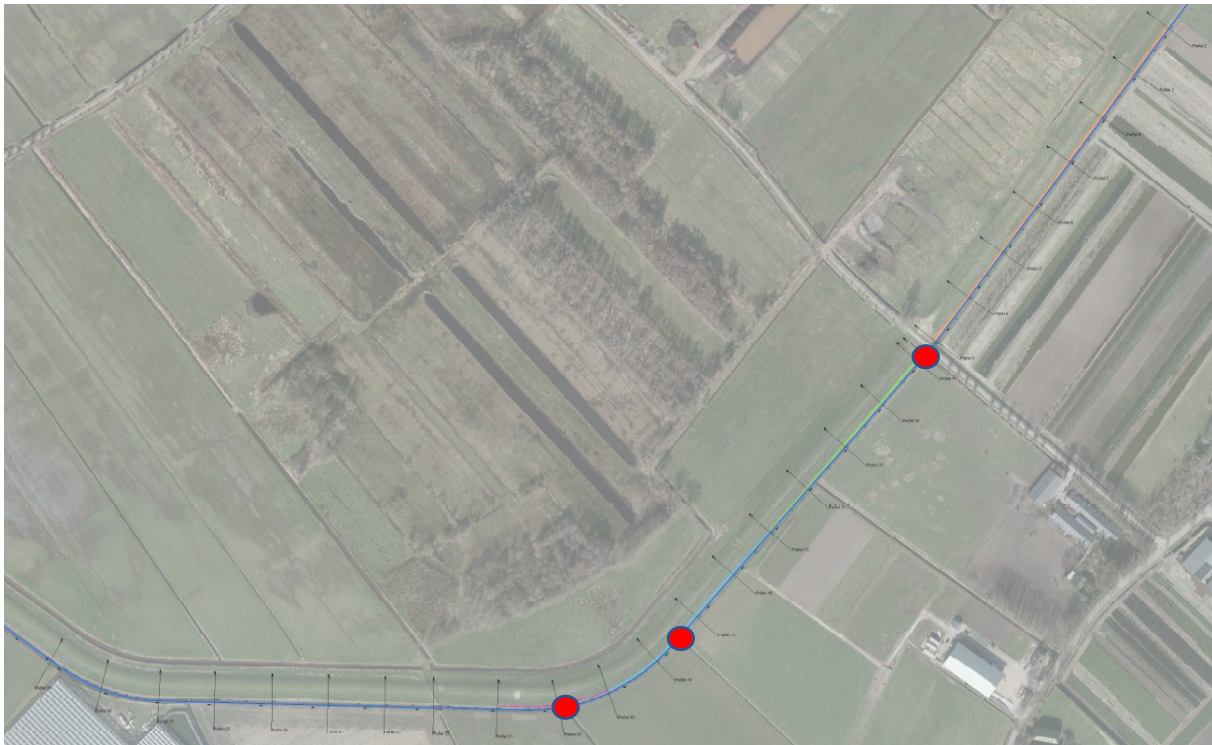
Figuur 4.3d: Tracé verbreding teensloot, op de rode stippen worden de duikers aangepast
