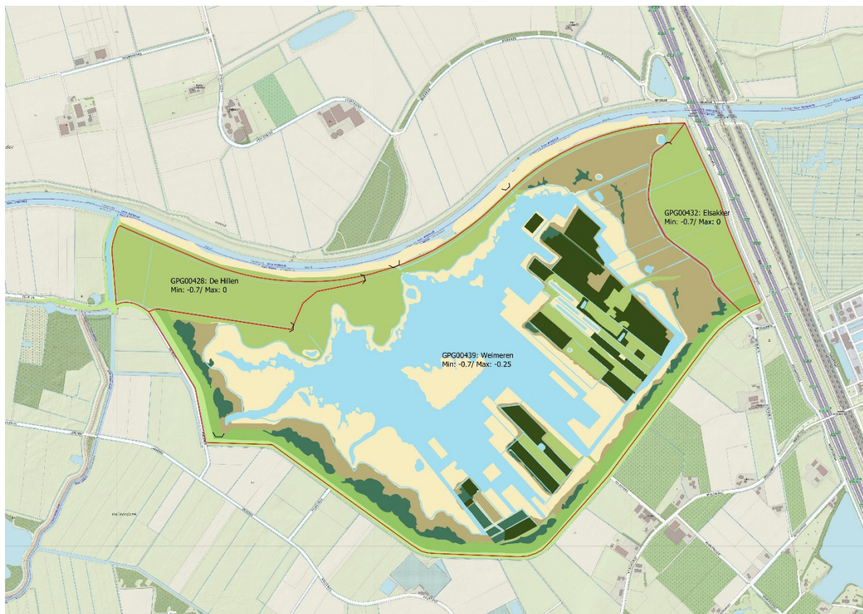
Figuur 7: Waterkaart Weimeren (zie ook bijlage 4) met de nieuw voorgestelde waterpeilen en het aangepaste watersysteem
