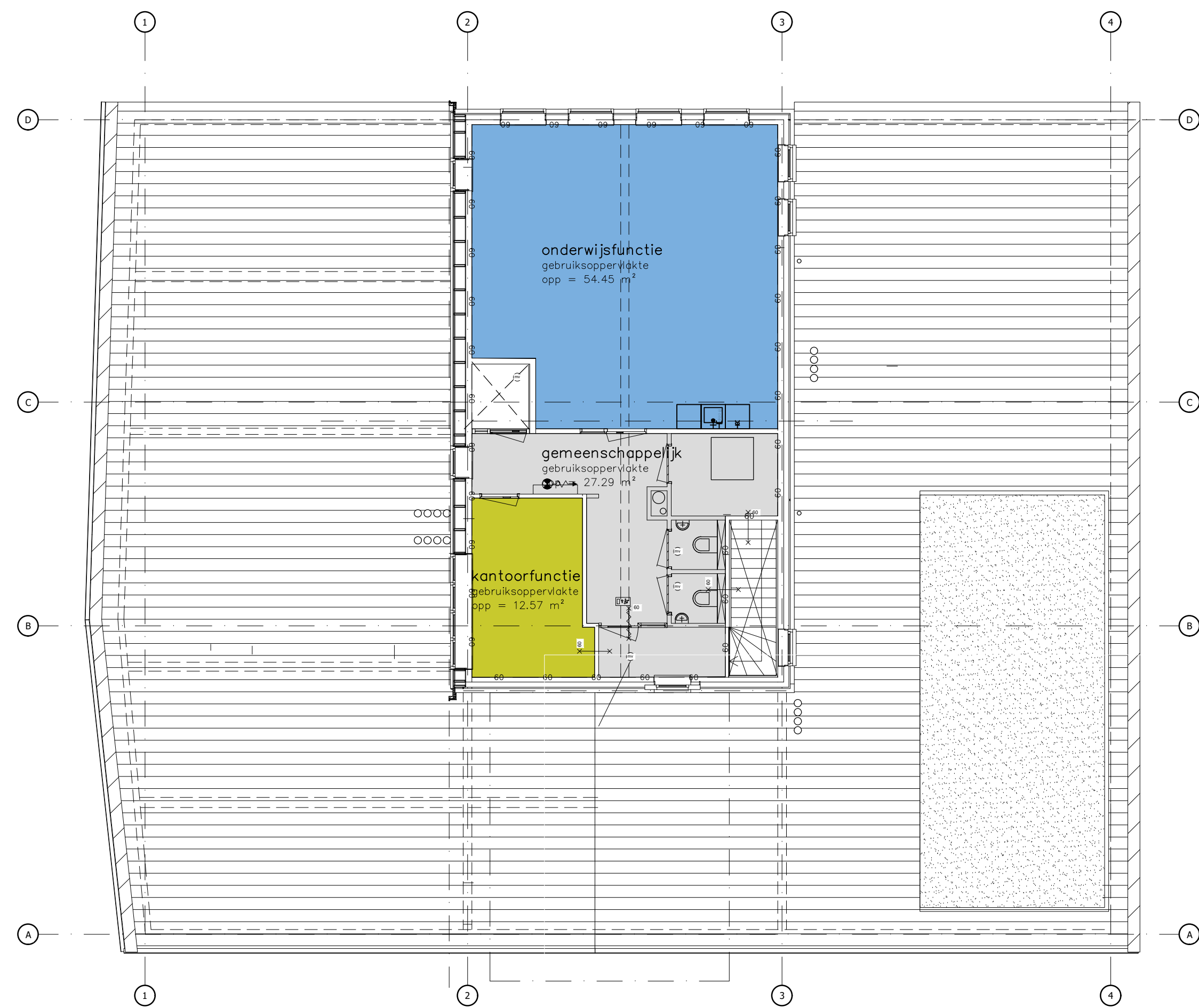
plattegrond tweede verdieping nieuw BVO tweede verdieping opp = 123,31 m 2
