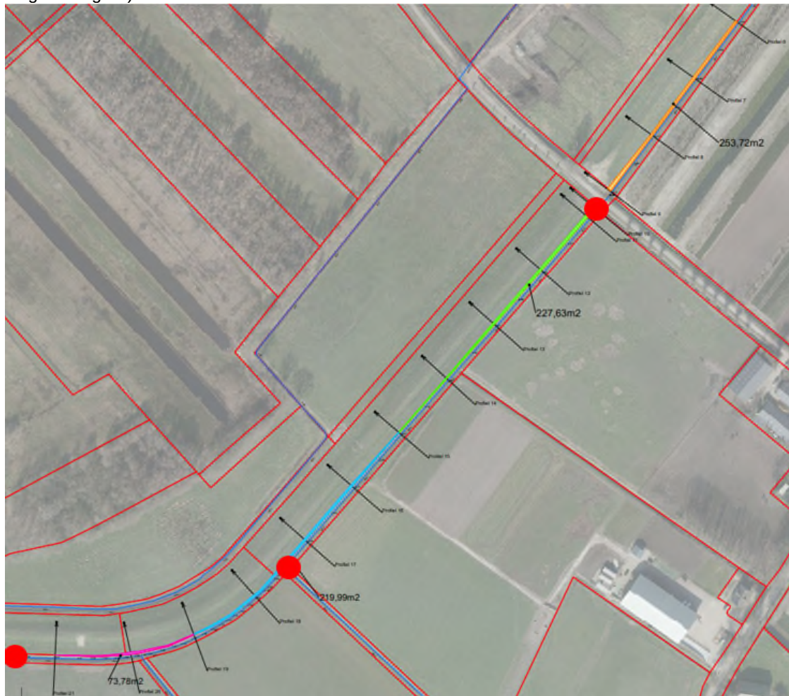
Figuur 4.10 Tracé verbreding teensloot, op de rode stippen worden de duikers aangepast
