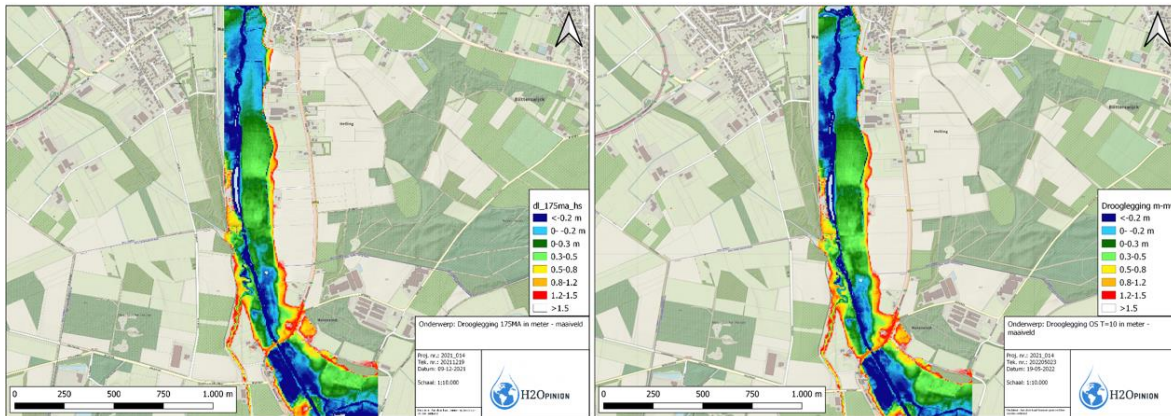
Figuur 11: Drooglegging gedurende een jaarlijkse piekafvoer (175% MA, ca. 1x/10 jaar); huidige situatie (links) versus ontwerpsituatie (rechts)
