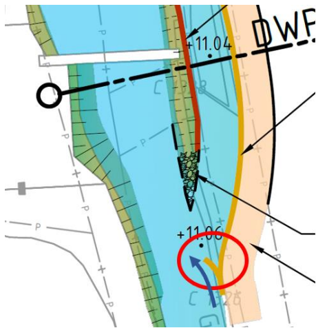
Figuur 14: Ontworpen vuil geleiding maatregel ter hoogte van de kruid-vuilvang (bron: ViForis, Grootte Molenbeek Wanssum zand- en vuilvang 1327-SIT-T01-02-1, 28-4-2022)
