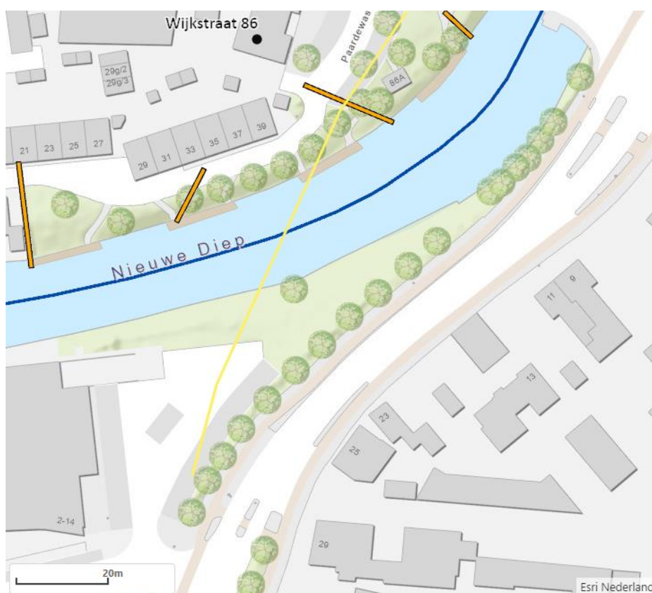
Figuur 1: Locatie van werkzaamheden. De gele lijn geeft de uit te voeren boring weer. De oranje lijn betreft de hemelwaterafvoer buis
