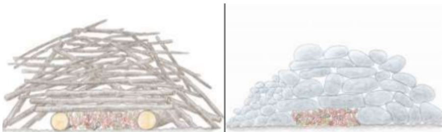
Figuur 4: Tekening van takken- en steenhoop als vervangende verblijfplaats voor steenmarter.
