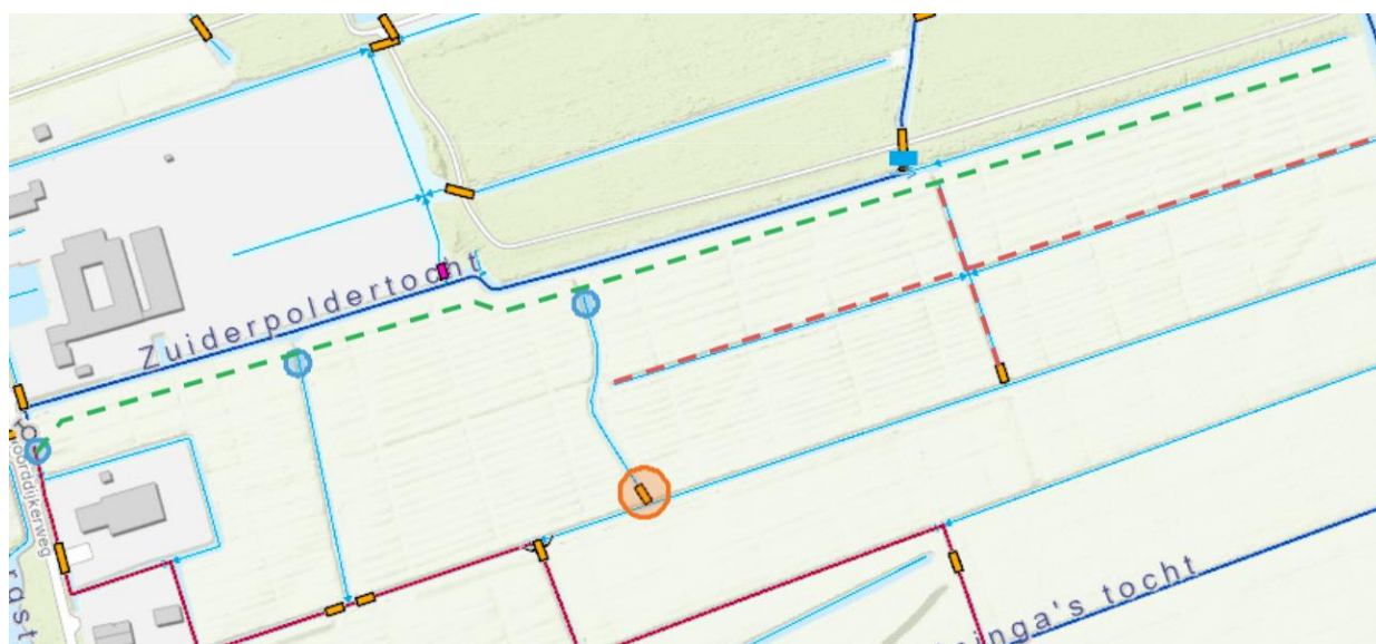
Figuur 1: Weergave te dempen sloten (rode stippellijnen), te graven sloot met open verbindingen op drie aangrenzende sloten (groene stippelijijn met blauwe cirkels), aan te passen duiker (oranje cirkel).
