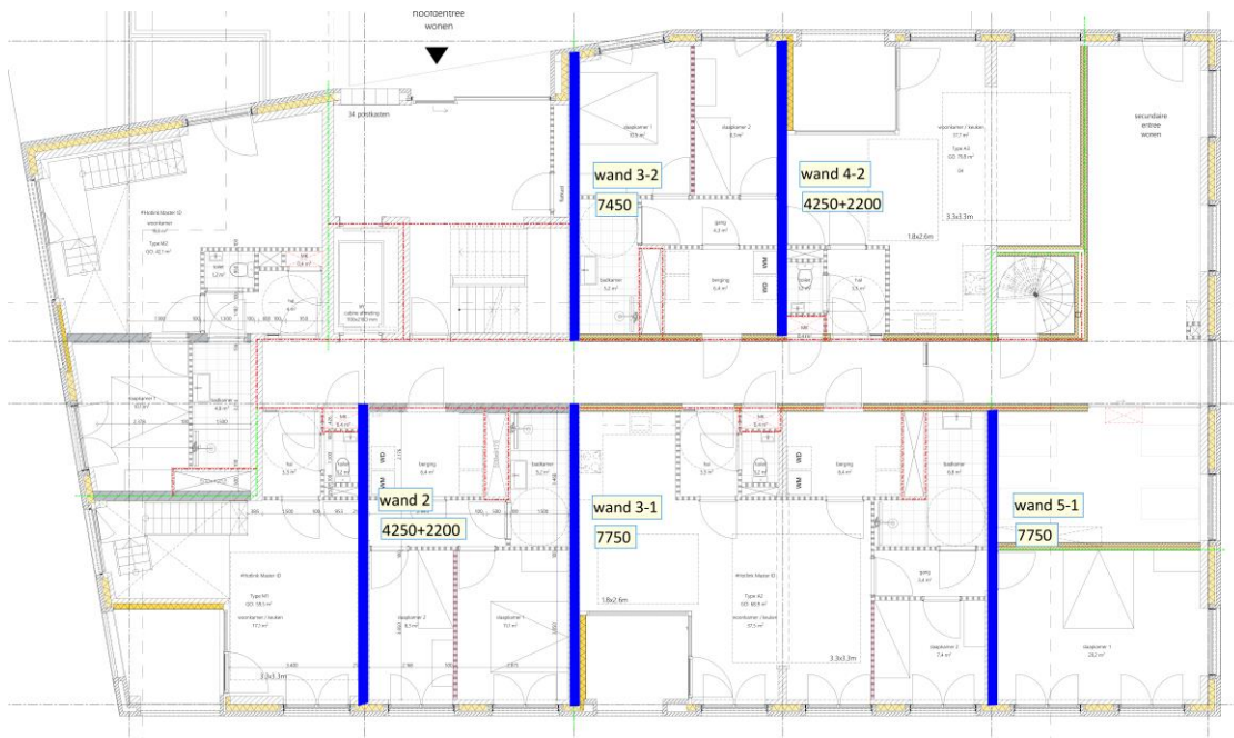
Afbeelding 2: aanwezige stabiliteitswanden in dwarsrichting op de begane grond
