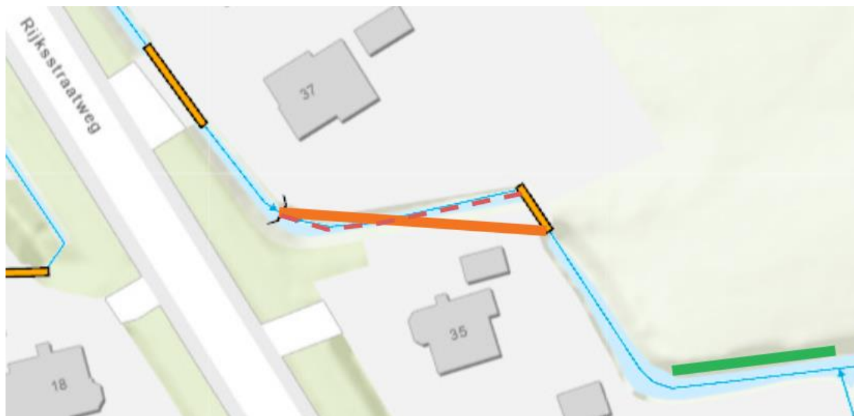
Figuur 1: Te dempen gedeelte weergegeven met rode stippellijn, aan te brengen duiker weergegeven met oranje lijn en gedeelte te verbreden watergang weergegeven met groene lijn.
