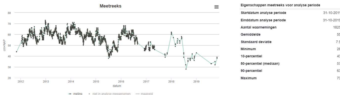
Figuur 3. Stijghoogte eerste watervoerend pakket conform TNO peilbuis B49D0056.
