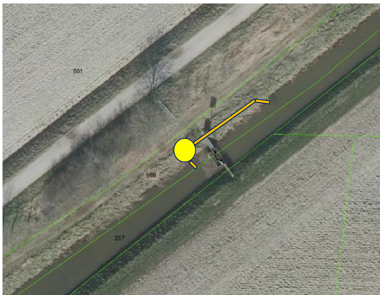
Figuur 6. Inpassing van de Smart Vislift bij stuw Schenkeldijk.
