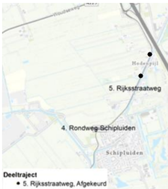
Figuur 2.2: Afgekeurd delen van de waterkering traject Rijksweg
