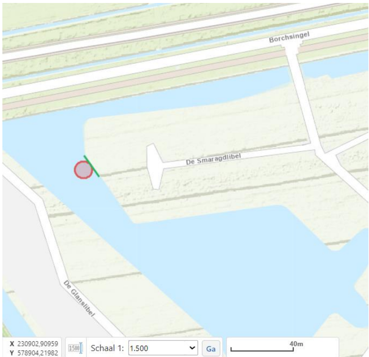
Figuur 1: Schematische tekening van de werkzaamheden. De groene lijn geeft globaal de locatie weer van de aan te leggen walbeschoeiing en de rode cirkel geeft globaal de locatie weer van de aan te leggen steiger.
