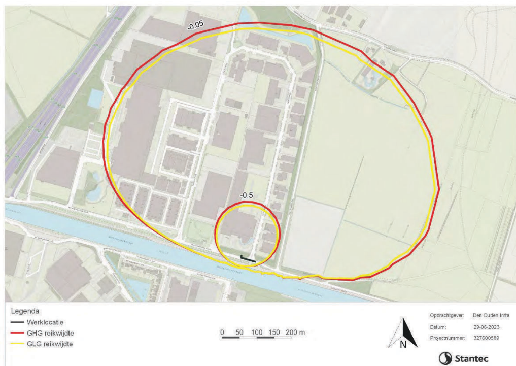
Figuur 6: Theoretisch invloedsgebied (verlagingscontour 0,05 meter en 0,5 meter) bij bemaling onder GHG (rode lijnen) en GLG (gele lijnen).
