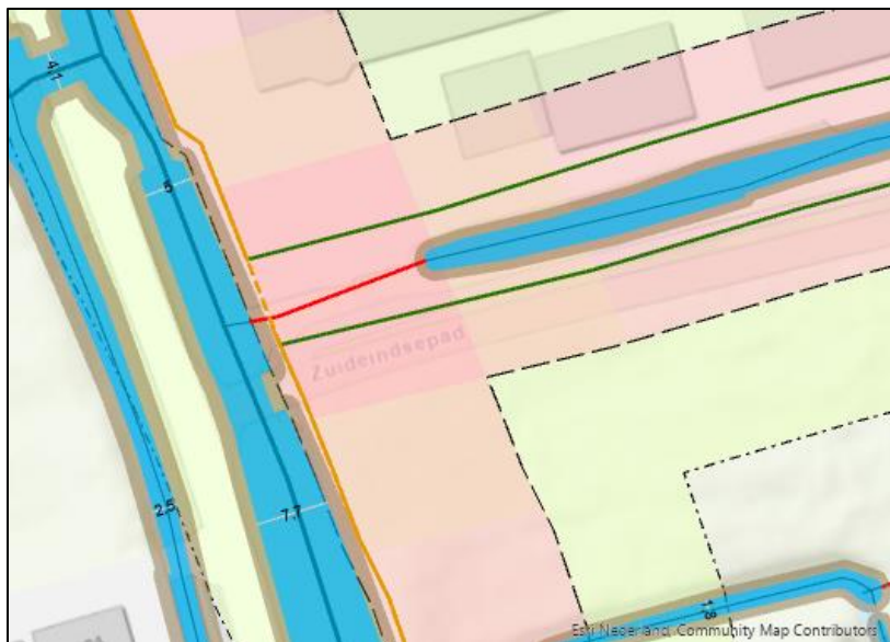
Figuur 2: Regionale kering Zuideindsepad ter hoogte van Zuideindseweg 84 (gestreepte lijn geeft de doorgetrokken buitenkruinlijn van de waterkering weer).
