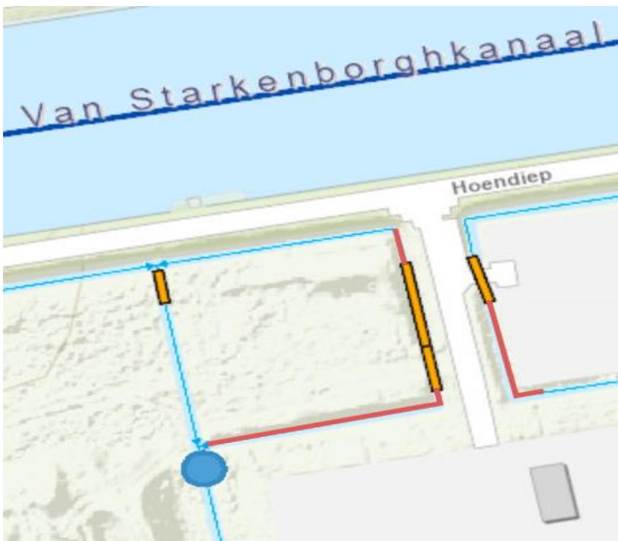
Figuur 1: Weergave bestaande duikers weergegeven met oranje lijnen, tijdelijke slootdempingen weergegeven met rode lijnen, de te plaatsen tijdelijke dam met duiker is weergegeven met een blauwe cirkel.
