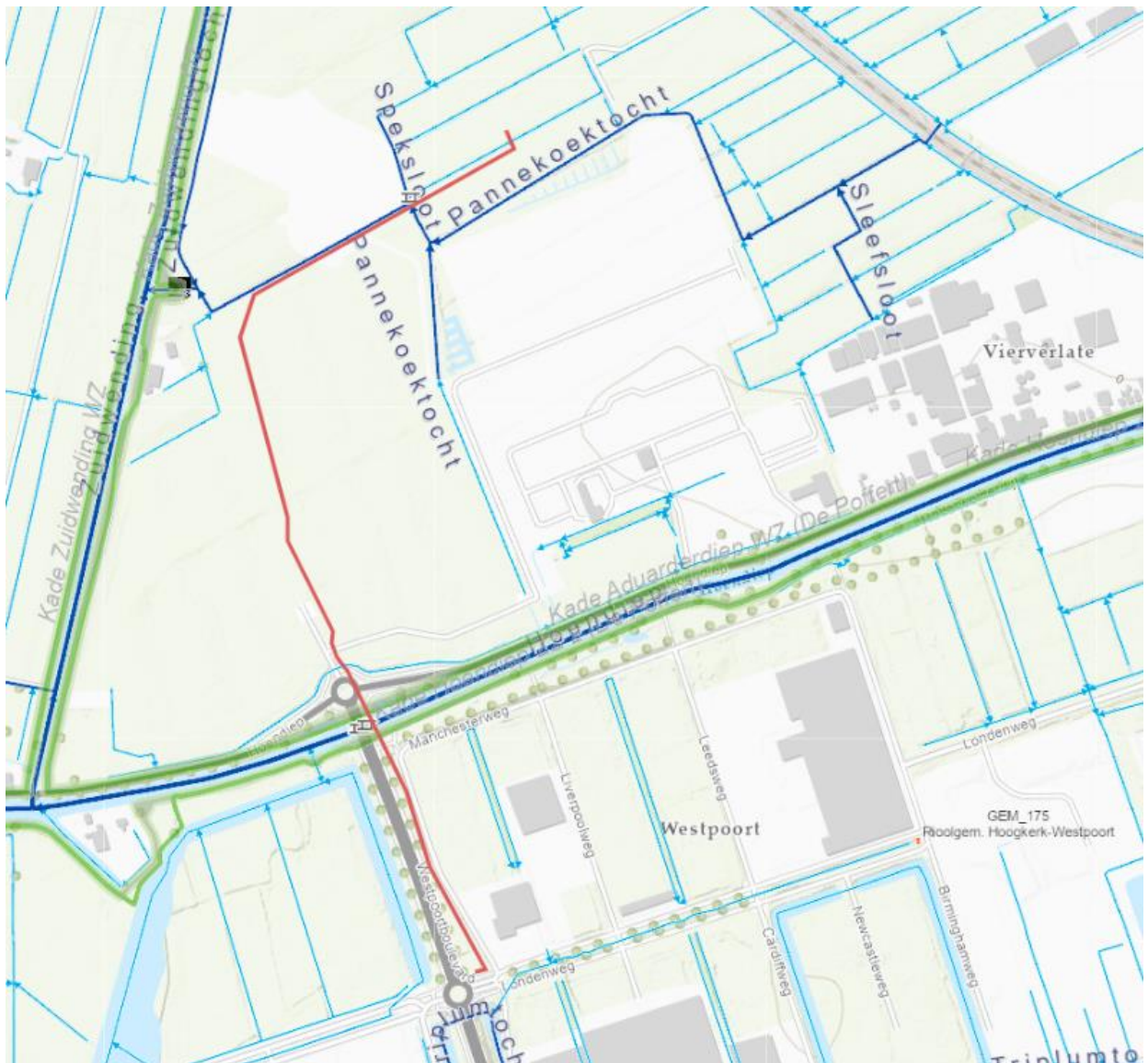
Figuur 1: Schematische tekening van de werkzaamheden. De rode lijn geeft globaal de locatie weer van het aan te leggen tracé.
