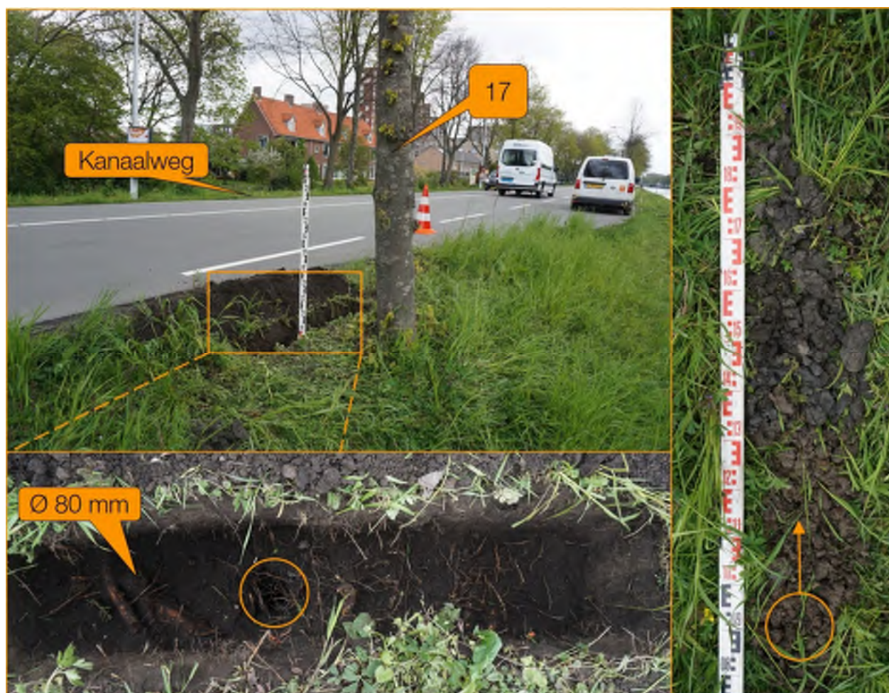
Foto 1: bodem- en bewortelingsprofiel profielsleuf 1.
