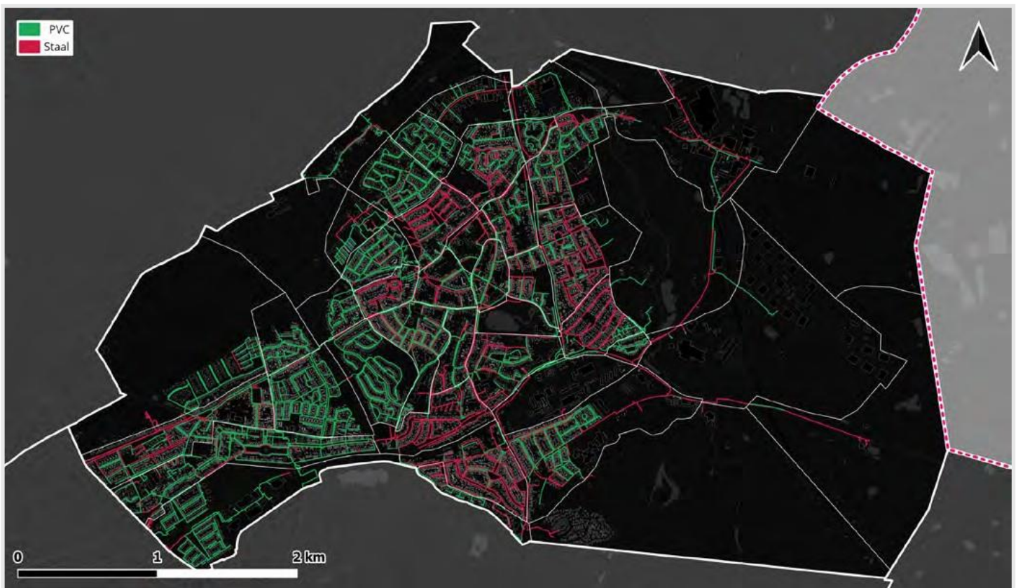
Figuur 3.4: Gasleidingen in Brunssum.
