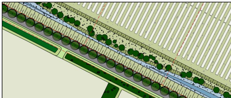
Figuur 26 Grondlichaam met struweel langs Bosweg
