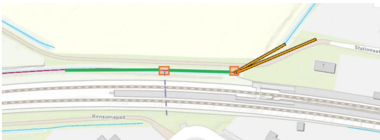
Figuur 1: Ingediende schets van de uit te voeren slootdemping/aanbrengen duiker van 500 mm diameter (in groen), tweetal aan te brengen inspectieputten (oranje vierkantjes) ter plaatse van (drie) bestaande uitmondende duikers (paarse stippellijn en dikke oranje lijnen).
