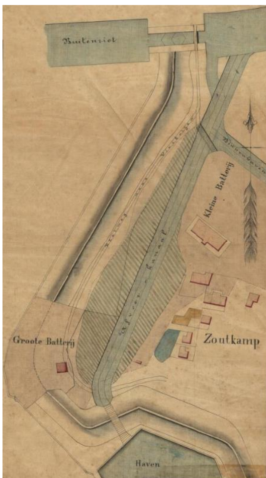
Figuur 30. Ongedateerde kaart betreffende de aanleg van een toevoerkanaal en spuisluis ter spuiing van de haven van Zoutkamp, 1861-1863. Bron: GA, nr. 817_3102.11.
