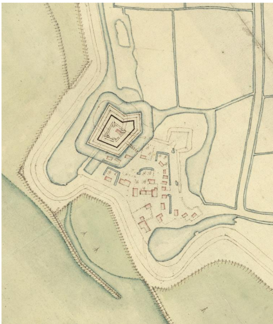
Figuur 15. 'Plan van de Soltcamp', ca. 1700-1800, met ten noorden van het dorp de hier in de vijftiende eeuw ontstane schans. Deze kaart geeft de schans weer in de opzet die na de verovering in 1589 ontstond. De in dunnen lijnen geschetste omvorming tot een bastion is slechts ten dele uitgevoerd. Bron: GA, nr. 1536_1137.
