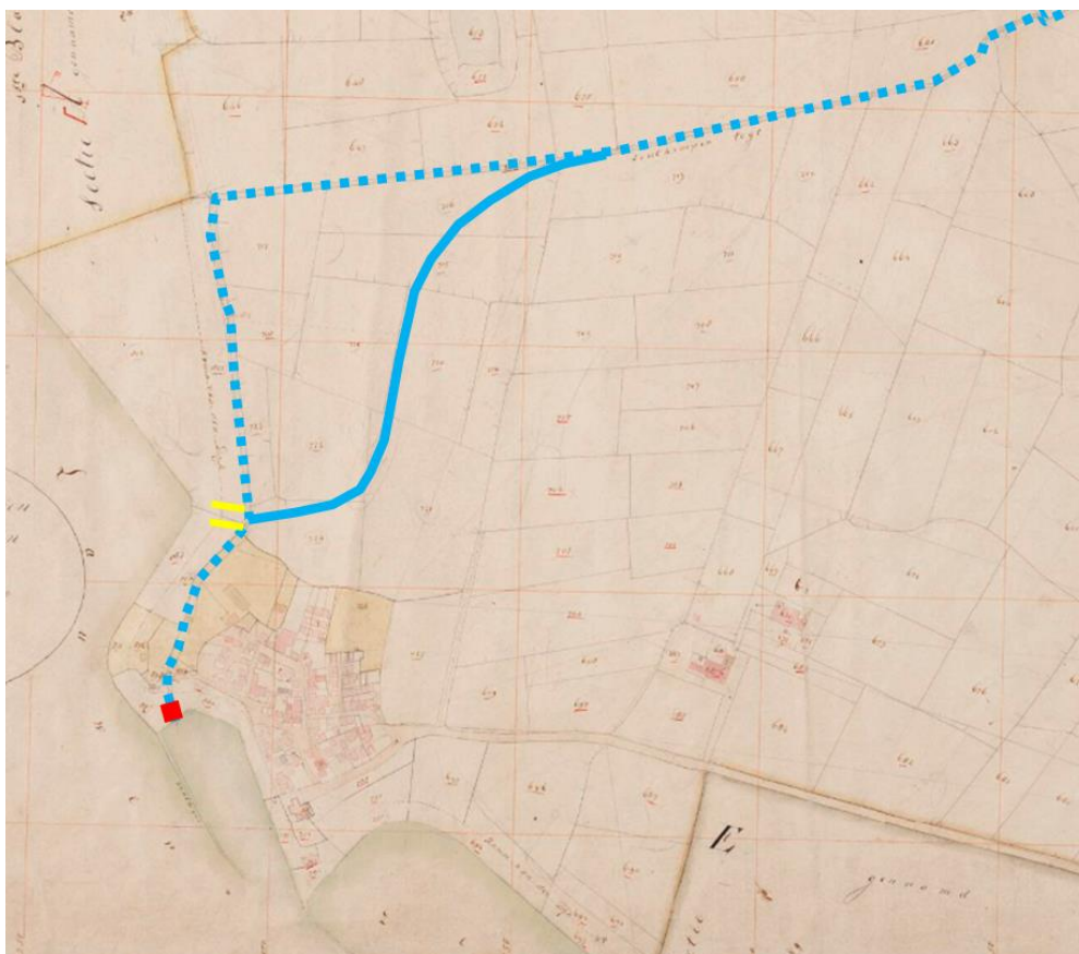
Figuur 20. Uitsnede Kadastrale kaart 1811-1832, gemeente Utrum, sectie F, blad 03. Hierop weergegeven het tracé van de Zoutkampertocht (gestippeld) en het latere tracé (globaal) van het Hunsingokanaal. De rode stip markeert de oude afwateringssluis bij de haven. De dubbele gele lijnen markeren de plaats van de Hunsingosluis. Bron: RCE, bewerking MAB.
