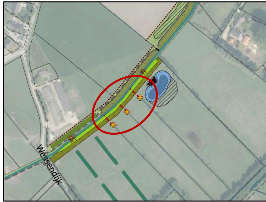
Figuur 3.14. Afdammen watergang en verwijderen duikers
