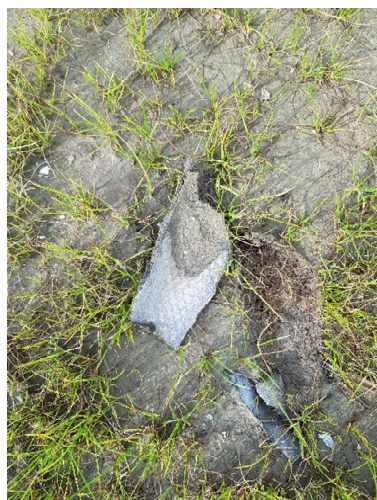
Foto 82: Situering toekomstig fietspad Zoutkamp-Electra (asbestverdacht materiaal op maaiveld)
