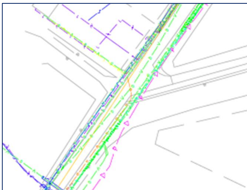
Figuur 10: Kabels en leidingen ter hoogte van kruising dijk met Postweg
