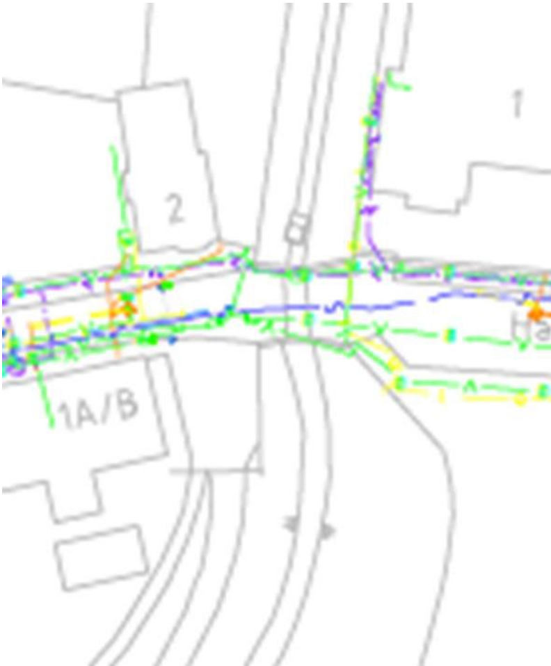
Figuur 25: Kabels en leidingen ter plekke van de coupure.
