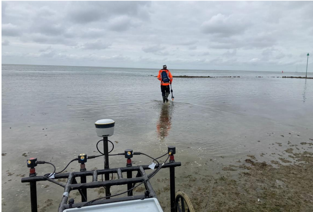
Afbeelding 13: EMI-metingen tijdens opkomend hoogwater, hetgeen geen goede meetresultaten oplevert. Bron foto: Saricon.
