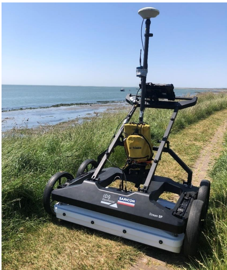
Afbeelding 3: GPR-schema en veldmeting op het wandelpad op de dijk. Bron: Saricon.
