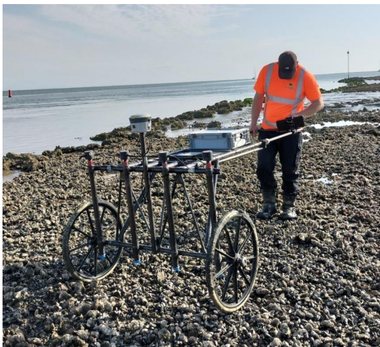
Afbeelding 4: MAG-schema en veldmeting op het wad (mosselbank). Bron: Saricon.
