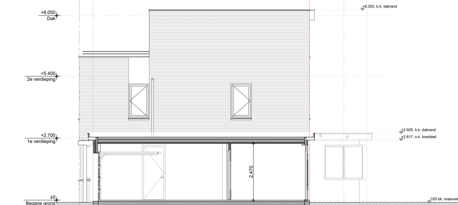
A doorsnede bestaande toestand
