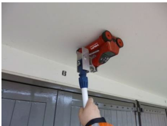
Figuur 5.4: Lijnscan(dekkings)meting Ferroskan aan de onderzijde van een galerijvloer.
