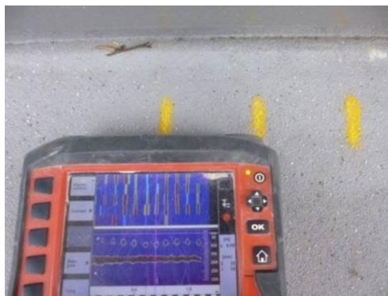
Figuur 5.5: Uitzetten boorlocaties en lijnscan-meting met de 3D-Betonradar.
