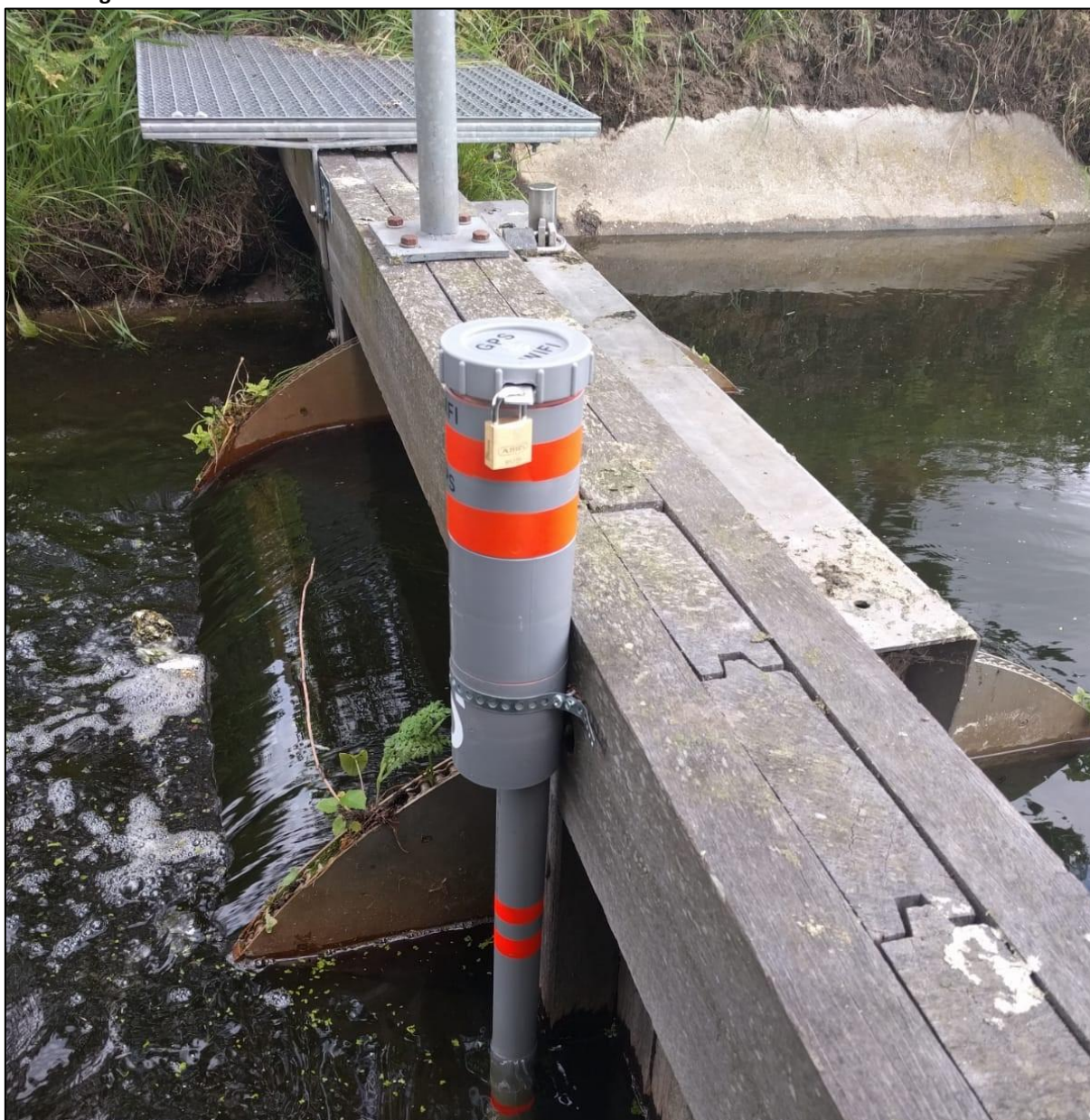
Abbeelding: Controle van de waterkwaliteit met meetsensor
