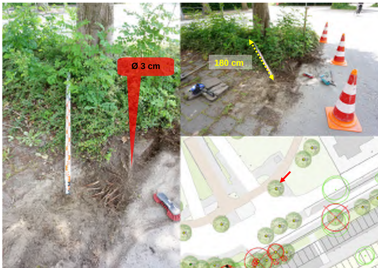
Profielsleuf 4: Overzichtsfoto en locatie (rechtsboven) en detailfoto van de profielsleuf (Links). De rode pijl rechtsonder geeft de locatie van de proefsleuf weer, de dunne belijning situeren het ontwerp.
