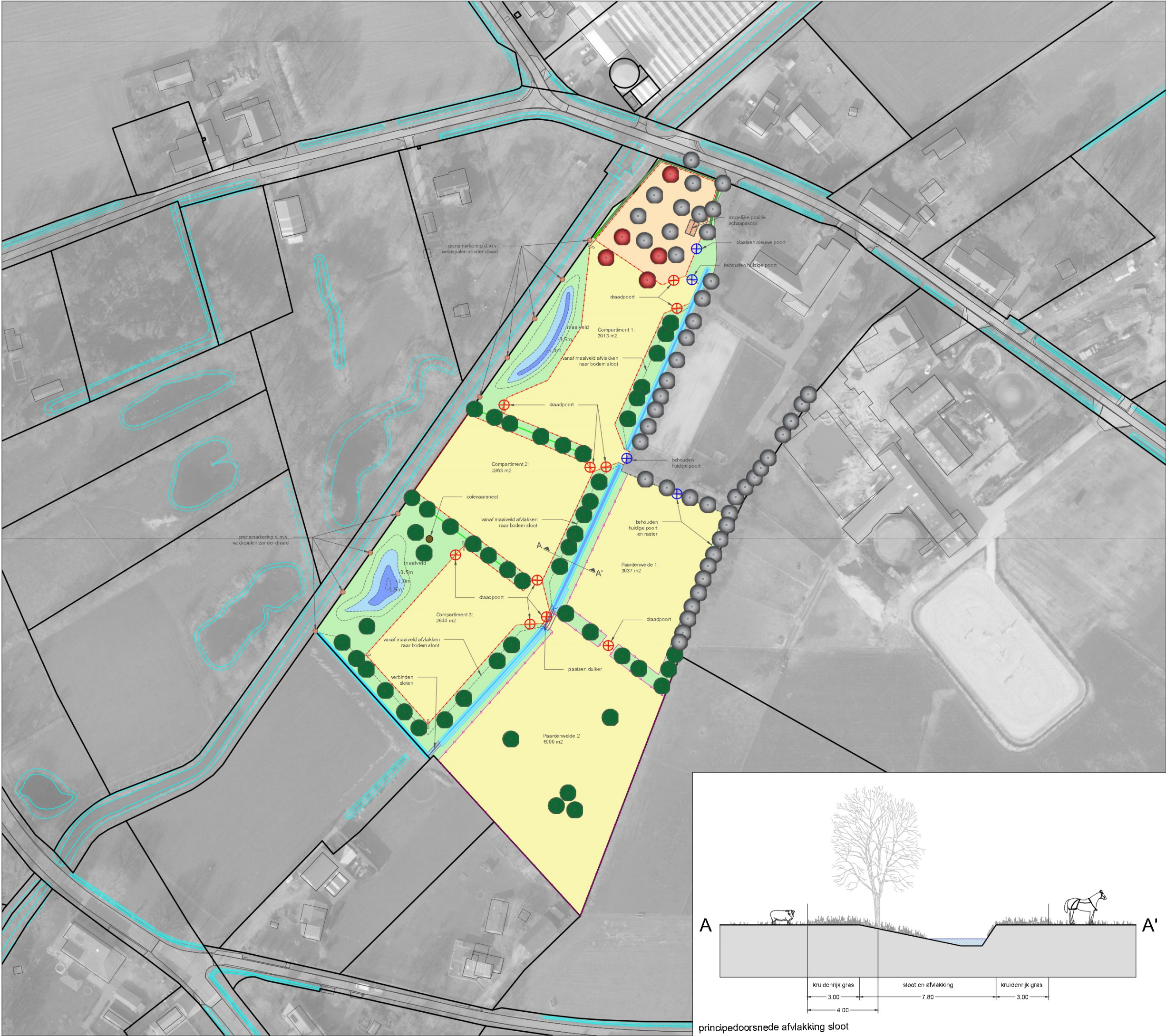
principeddoorsnede afvlakking sloot
