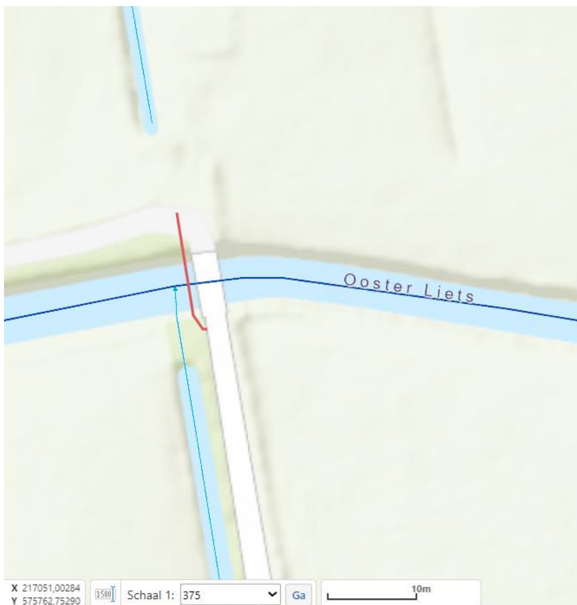
Figuur 1: Schematische tekening van de werkzaamheden. De rode lijn geeft globaal de locatie weer van de aan te leggen boogzinker.
