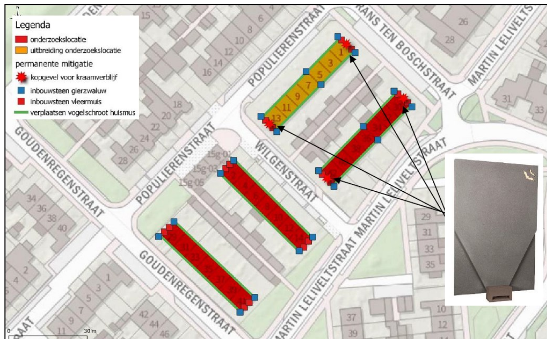
Figuur 4: Overzicht van de locaties van de permanente mitigerende maatregelen binnen het plangebied. Verdeeld over alle kopgevels worden in totaal 16 inbouwstenen voor vleermuis geplaatst (rood vierkant), 4 inbouwkraamkasten voor vleermuis (rode ster) en minstens 10 inbouwstenen voor gierzwaluw (blauw vierkant; initiatiefnemer is voornemens om voor gierzwaluw overcompensatie te realiseren, daarom zijn er op de kaart 20 locaties weergegeven). Voor huismus (groene lijnen) wordt het dak geschikt gemaakt door het terugplaatsen van vogelschroot. Afbeelding: Econsultancy 2023.
