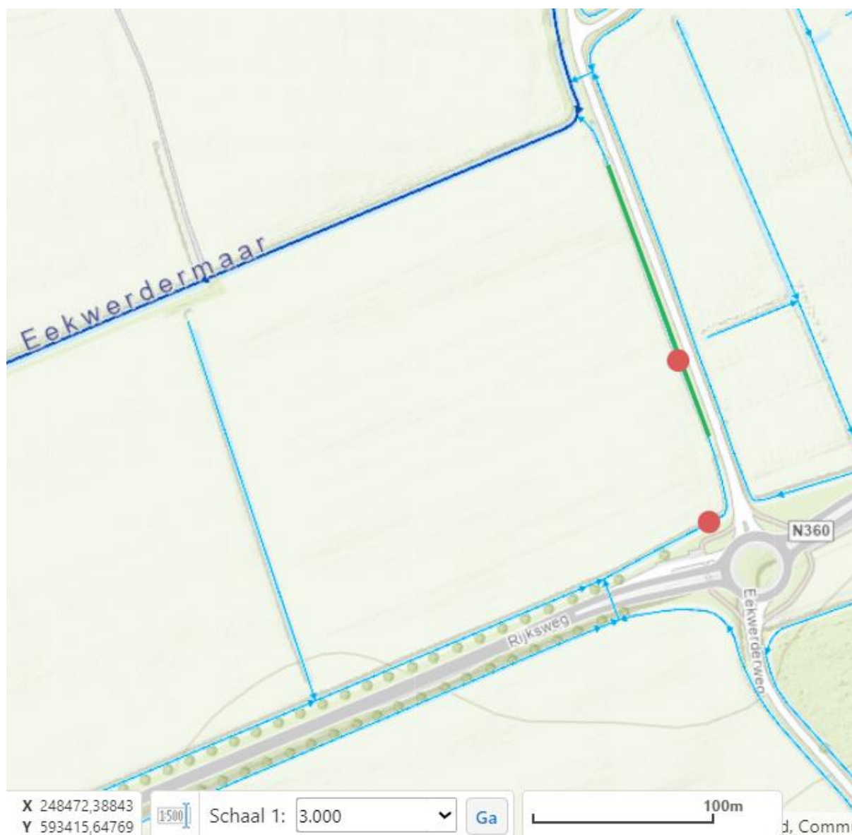
Figuur 1: Schematische tekening van de werkzaamheden. De groene lijn geeft globaal de locatie weer van de te verbreden watergang en de rode stippen geven globaal de locatie weer van de aan te leggen dammen met duiker.
