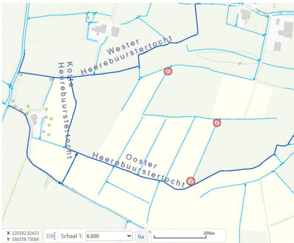
Figuur 1: Schematische tekening van de werkzaamheden. De rode cirkels geven globaal de locatie weer van de aan te leggen dammen met duiker.
