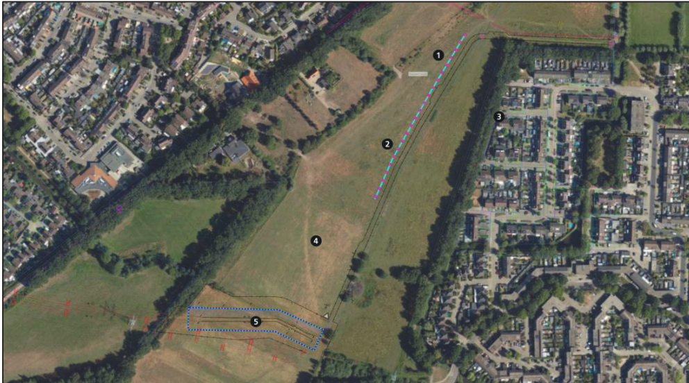
Afbeelding 13 – Peilbuizen (retour-)bemaling tussen mast 44 en 45
