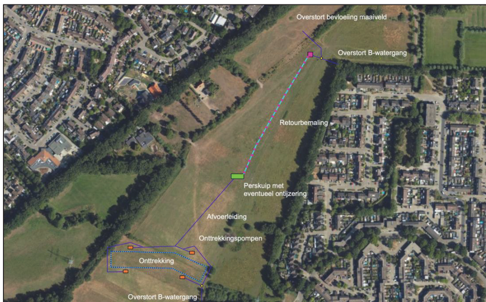
Afbeelding 8 – Voorstel bemaling en retourbemaling tussen mast 44 en 45
