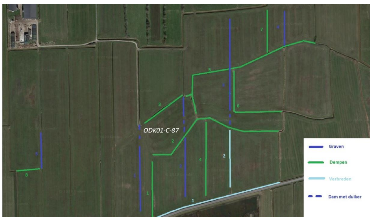
Figuur 1: Overzichtstekening diverse werkzaamheden.
